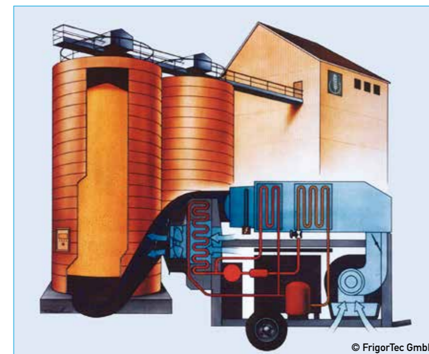
7 Princípio do processo do refrigerador de cereais GRANIFRIGOR™
